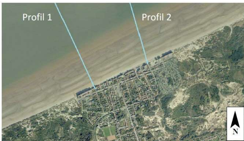
Illustration 37: Position des deux profils de plage utilisés pour les calculs de débits de franchissement pour la digue-promenade de Bray-Dunes (Étude de détermination de l'aléa submersion marine intégrant les conséquences du changement climatique en région Nord-Pas-de-Calais, 2013).
